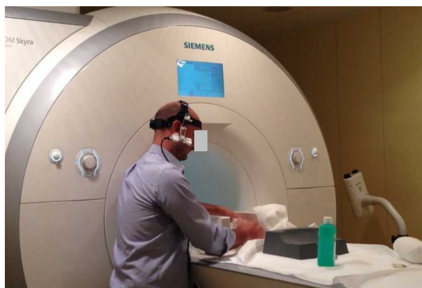
Figura 5: misura dell'induzione magnetica percepita (pMFD) in caso di movimento nel campo magnetostatico, nel corso dell'esecuzione di movimenti tipici per la preparazione di un esame RM.
